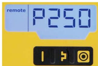
Состояние блокировки клавиатуры сохраняется при включении и выключении устройства. При сбросе настроек памяти блокировка снимается. При системе управления пистолетами OptiStar CG08(-C) (автоматическое устройство) может произойти и внешняя блокировка через вход удалённого доступа. Оба вида блокировок не зависят друг от друга. Это означает, что при снятии локальной блокировки внешняя блокировка остаётся, и наоборот.
