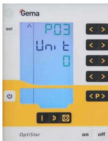
Данным параметром определяется массовая единица для всех типов воздуха (совокупного воздуха и продувочного воздуха для электродов). При установке параметра равным **1 (scfm)** все значения воздуха отображаются в данной массовой единице. На дисплее эти строки светятся **СИНИМ** цветом.
