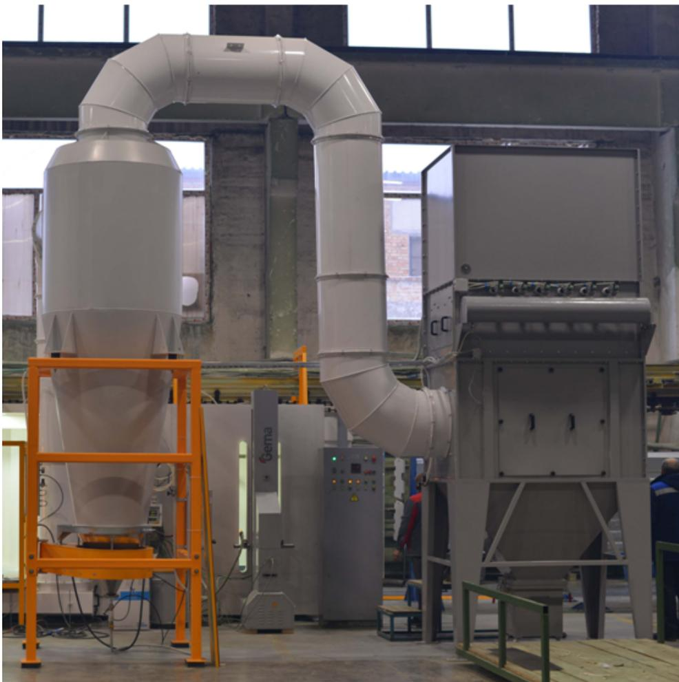
Состоит из циклона и конечного фильтра соединённых между собой воздуховодами. Высокпроизводительная система вентиляции исключает выброс порошка за пределы окрасочной камеры и обеспечивает чистоту в помещении окрасочного цеха.
