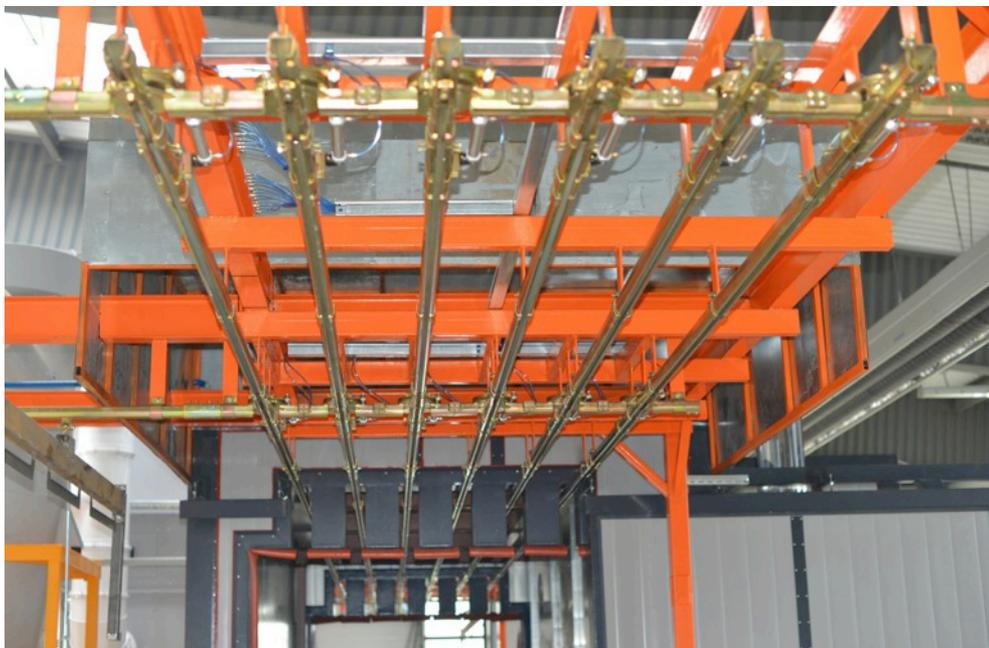
**Самый простой и доступный тип конвейеров, который применяется для не больших участков окраски,, все перемещения деталей осуществляет оператор. При относительной простоте, данный вид конвейера способен перемещать значительный вес ( до 4000 кг.) без применения электропривода.**
