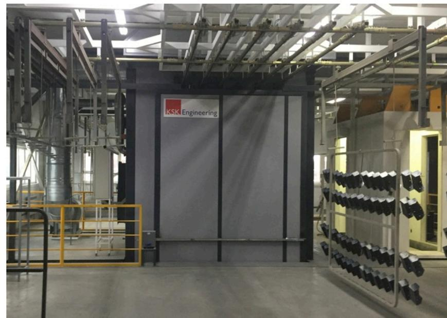
**Печи полимеризации предназначены для формирования порошкового полимерного покрытия под воздействием температуры.**
