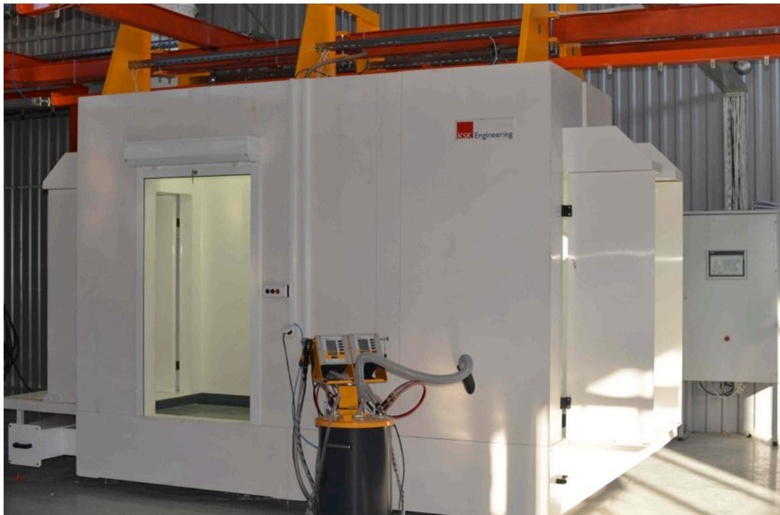
Корпус окрасочной камеры изготавливается из высокопрочного пластика методом горячей сварки по технологии сэндвич-конструкция, что придаёт камере необходимую жёсткость и гарантирует отсутствие статических зарядов на корпусе. Уникальные антистатические свойства материала позволяют избежать наслоений порошка во время работы и производить быструю и лёгкую очистку при смене цвета.
