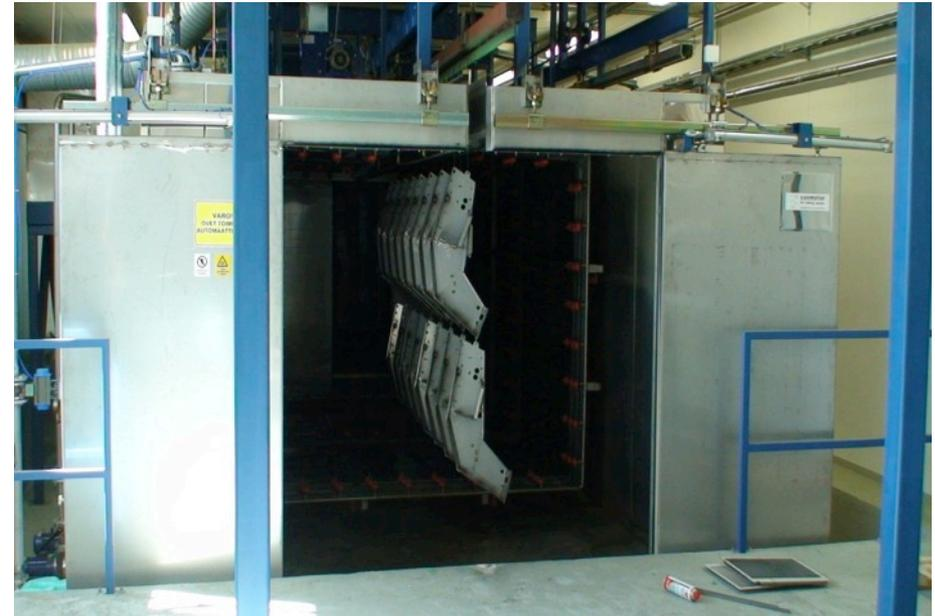
Как правило в подобных агрегатах хим. подготовки изделия обрабатываются в одной зоне, проходя последовательно несколько стадий обработки. Длительность обработки одной загрузки составляет 15 – 20 мин. Затем изделия должны быть помещены в сушильную печь для удаления влаги.
