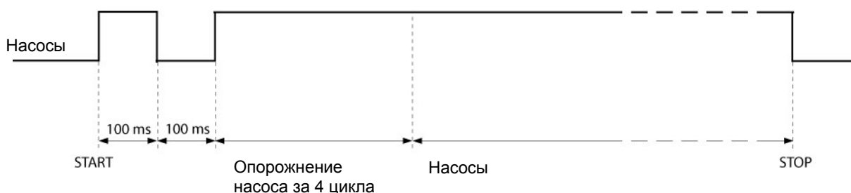
Диаграмма синхронизации - Соединение через Control/PLC 2.1
